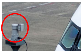
自社製カメラを用いた航空機追尾監視システム
