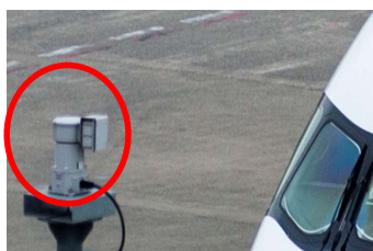
自社製カメラを用いた 航空機追尾監視システム
