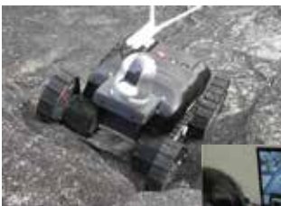
当社製品 監視点検用遠隔操作 クローラーロボット(上)
