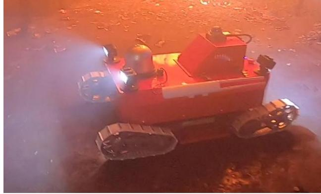
災害初期に遠隔操縦ロボットが災害・経路の状況を探査します。
